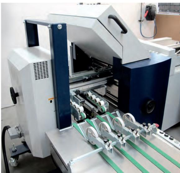
*Das Schwertfalzwerk MS 45 ist mobil und höhenverstellbar und kann so flexibel eingesetzt werden.*
