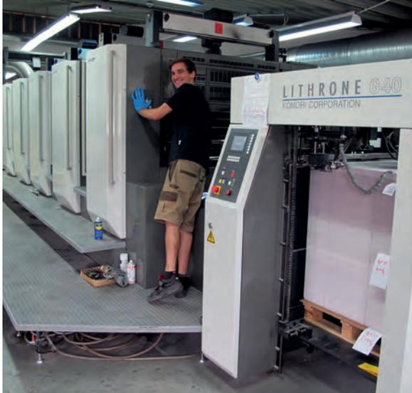
*Die Komori Greenline 540 HCV kommt ganz ohne Verwendung von Puder aus, so dass die üblichen Trocknungszeiten entfallen (hier mit Offsetdrucker Elia Wende).*
