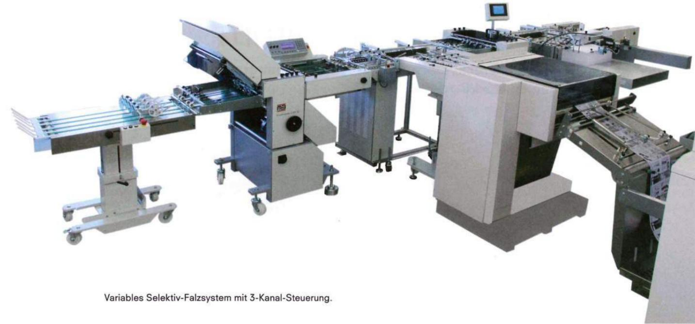
Variables Selektiv-Falzsystem mit 3-Kanal-Steuerung.
