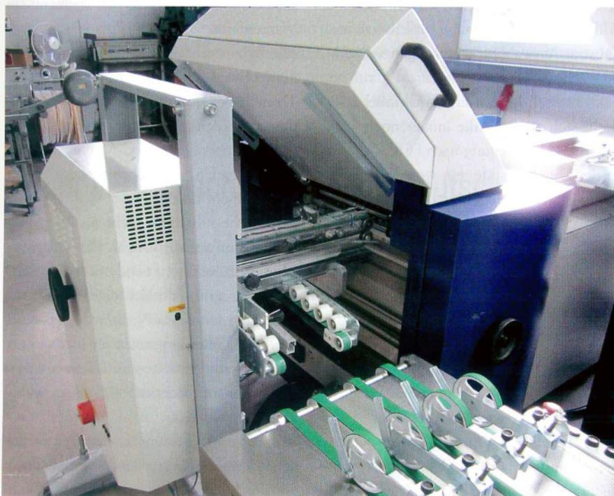
Das Schwertfalzwerk MS 45 ist mobil und höhenverstellbar und kann somit problemlos an verschiedenen Positionen innerhalb der Falzanlage eingesetzt werden.
