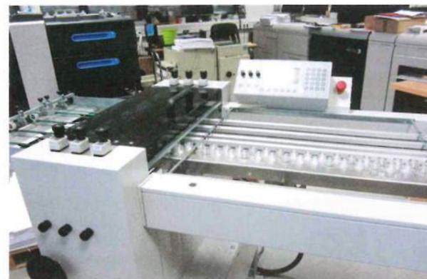
Nutzwertige Komponente: Das Schneidmodul CM 52 mit drei Wellenpaaren für Schneid-, Perforier- sowie Rillwerkzeuge ist mobil und höhenverstellbar und kann beliebig innerhalb der Maschinenkonfiguration eingesetzt werden.
