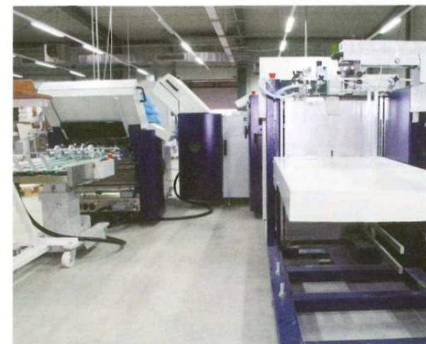
Der Flachstapel-Anleger ist auf die Weiterverarbeitung von Planobogen mit einer maximalen Länge von 130 cm ausgelegt.
