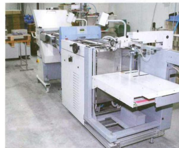
Das Falzsystem multimaster CAS 52 wurde um ein Balkenrillensystem sowie einen Flachstapel-Anleger mit Ausrichtstrecke ergänzt.
