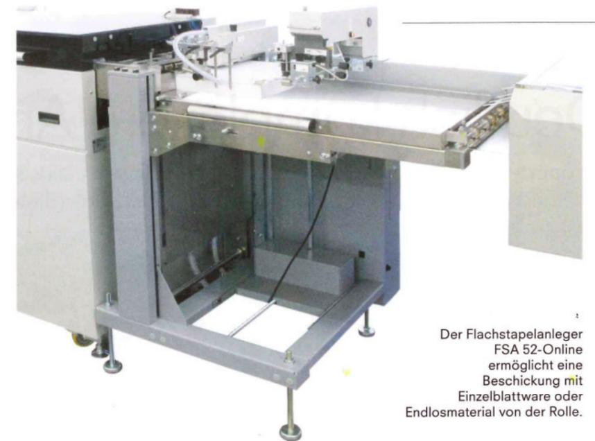
Der Flachstapelanleger FSA 52-Online ermöglicht eine Beschickung mit Einzelblattware oder Endlosmaterial von der Rolle.
