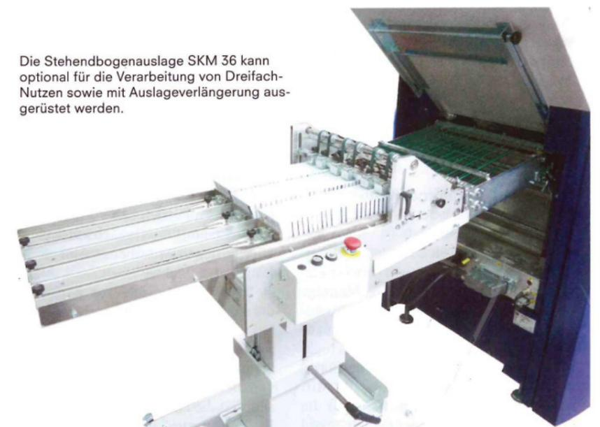
Die Stehendbogensauslage SKM 36 kann optional für die Verarbeitung von Dreifach-Nutzen sowie mit Auslageverlängerung ausgerüstet werden.
