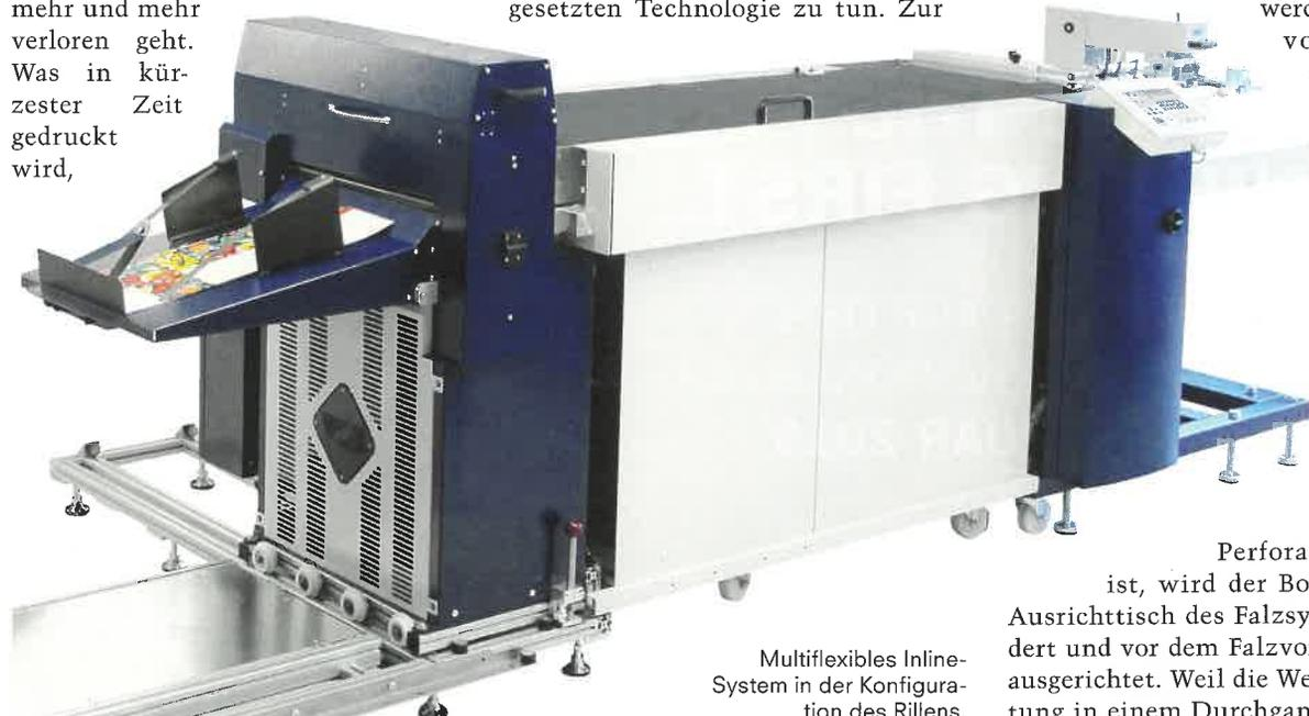
Multiflexibles Inline-System in der Konfiguration des Rillens.
