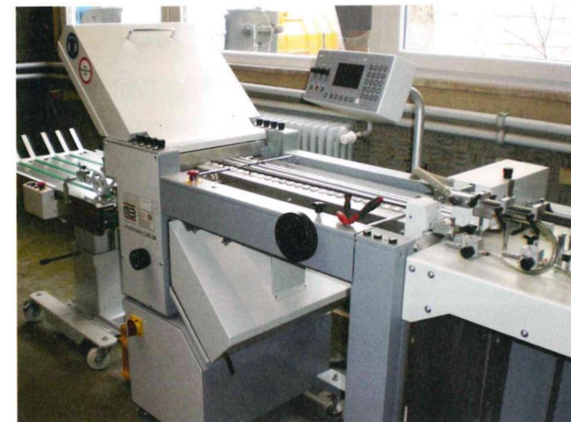
Auf zwei automatisierten Falzmaschinen der Baureihe Multimaster CAS 38 werden verschiedene Falzaufgaben sowie die Herstellung von Selfmailern erledigt.
