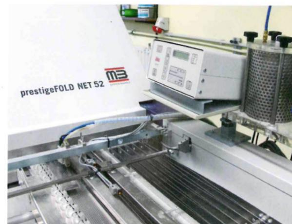
Zusätzliche Ausrüstung: Eines der Falzsysteme Prestige-Fold Net 52 ist mit einer Kaltleimeinrichtung ausgestattet.
