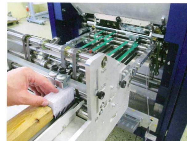
Weitere Optionen: Das einhängbare Zusatzfalzwerk erhöht die Falzvariabilität und ermöglicht Kleinfaltungen von 18 mm.
