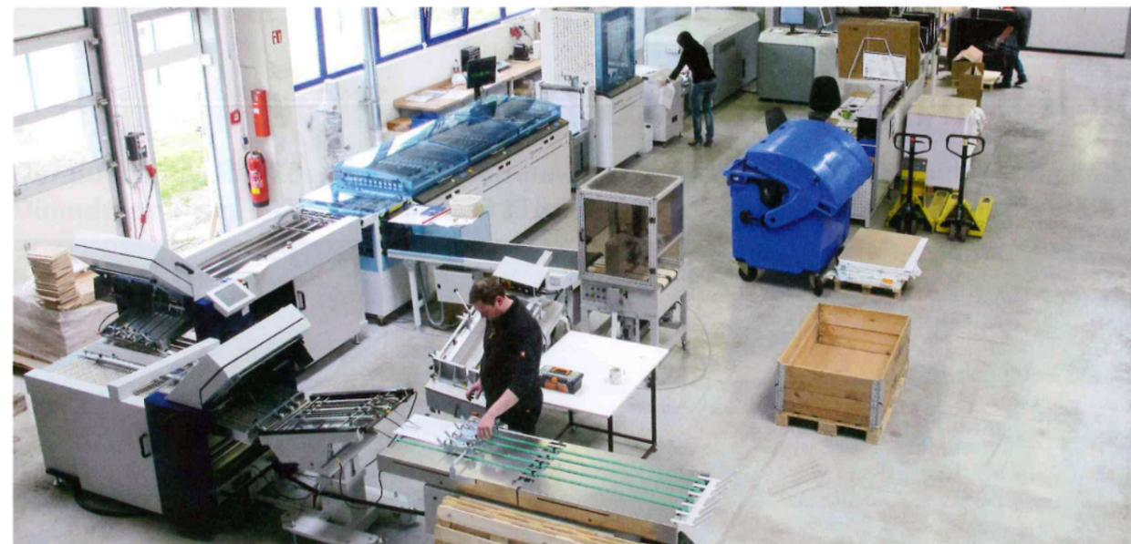
Integrierte Digitaldruck-Fertigung: Die neue Produktionslinie ermöglicht die Inline-Fertigung von der Rolle bis zum gefalzten (End-) Produkt auch für niedrigere Auflagen.
