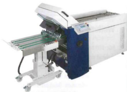
Das vollautomatische Falzsystem prestigeFOLD NET 52 mit langem Ausrichttisch ART 52 verarbeitet auch Bogen mit einer Länge von bis zu 132 cm.
