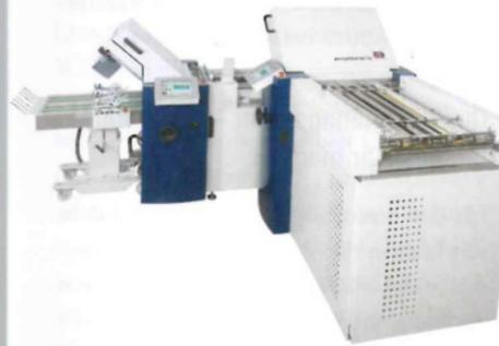
Das Kreuzbruchfalzsystem prestigeFOLD NET 52 mit Doppelausrichttisch DAT 24 ermöglicht ein- oder zweibahnige Produktion.
