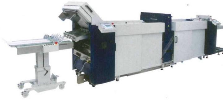
Die Komponenten des Multiflexiblen Inline-System sind auf Schienen montiert, so dass diese je nach Einsatzzweck passend positioniert werden können.
